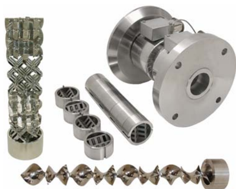
Figura #1: Mezclador StaMixCo SMB para Extrusión con Carcaza Bridada, Bandas de Calentamiento y Termocople con tres (3) tipos de diseño de elementos mezcladores
