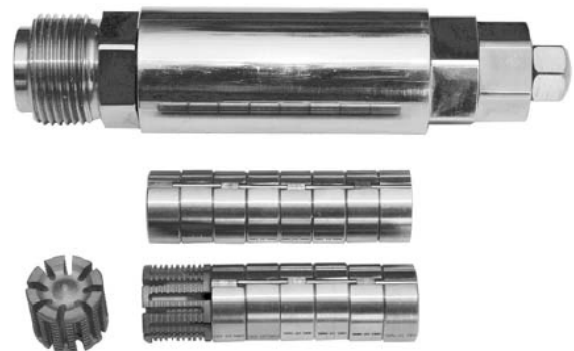
Figura #4: Boquilla de mezclado SMN completa sin bandas calentadoras ni termocople (arriba), Ensamble de ocho (8) elementos SMN (centro), y seis (6) elementos de mezcla SMN Combinados con un filtro SMF (abajo). Para mas información de los filtros SMF, ver el catálogo SMF-1.2 "Filtros SMF StaMixCo para Boquillas de Mezcla SMN".
