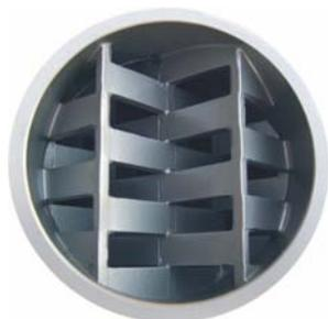
Los elementos de mezclado estático GXR son ideales para el mezclado / dispersión de fluidos viscosos. Los elementos mezcladores son virtualmente indestructibles, y además, cuando se requiere de limpieza, éstos se pueden retirar fácilmente presionándolos hacia afuera de la carcasa sin dañarlos. Las aplicaciones incluyen::
